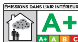
\* Information sur le niveau d'émission de substances volatiles dans l'air intérieur, présentant un risque de toxicité par inhalation, sur une échelle de classe allant de A+ (très faibles émissions) à C (fortes émissions).
