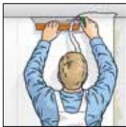
**6.** Enlever les excédents des plafonds, plinthes, fenêtres, etc. à l'aide d'une lame serpette, d'une spatule ou de ciseaux puissants.
