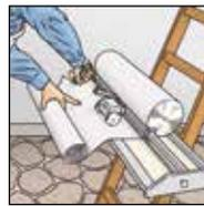
**2.** Couper ERFURT-KlimaTec KV 600 en laissant du rajout et le dérouler avec sa partie inférieure vers l'extérieur.
