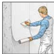
**4.** Appliquer le côté feutré du revêtement mural dans le système de collage humide selon la technique d'encollage mural en le disposant bord à bord à joints vifs. Lisser avec un rouleau en caoutchouc et/ou une spatule en plastique.
