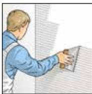
**3b.** Pour les supports moyennement et fortement structurés, appliquer le système de collage SR 4 perpendiculairement au sens du papier à l'aide d'une spatule crantée, en utilisant suivant le support la dentelure B2 ou C3.
