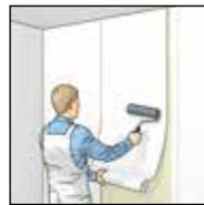
**7.** ERFURT-KlimaTec KV 600 doit être tapissé après le séchage. En tapissant, décaler les joints latéralement pour éviter un encollage bord à bord.
